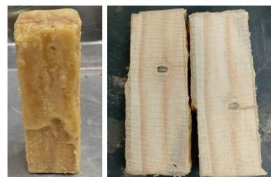
Figura 1. Corpo de prova submetido a impregnação pelo método de imersão.
