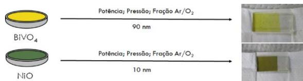
Figura 1. Condições de deposição dos filmes por *sputtering*.
